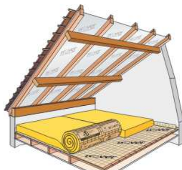
Pose de rouleaux ou de panneaux sur plancher
