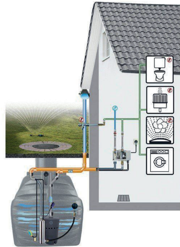
Récupération d'eau de pluie pour usage interne et externe à la maison - cuve enterrée
